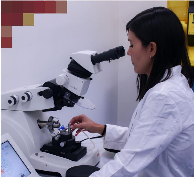
El ultramicrotomo facilita la preparación de cortes semifinos y ultra finos de tejidos. Para cortes semifinos se emplean cuchillas de vidrio y para ultra finos (menor a 60 nm) se utiliza la cuchilla de diamante.
