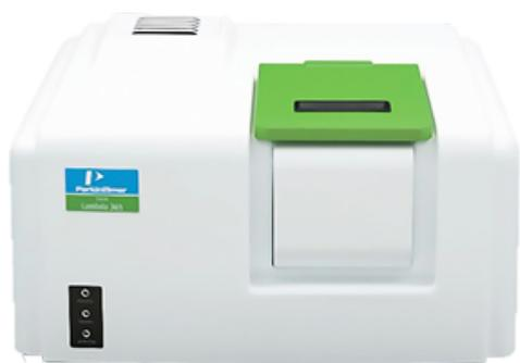
El Espectrómetro UV-vis, LAMBDA 365 Perkin Elmer tiene una interfaz de Tungsteno-Halógeno y deuterio y un rango de operación de 90-1100 nm. Cuenta con un accesorio de muestras sólidas para transmisión y reflectancia y una esfera integradora para mediciones de color.
